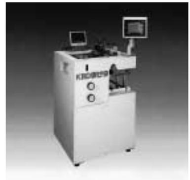
はタッチパネルを採用。版のセットだけでなく、トンボに対して直角に設定寸法通りの樹脂版カットもできる。
