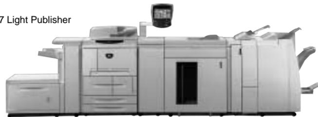
80枚/分(60~300g/m<sup>2</sup>)の高速度出力を実現。厚紙でも薄紙でも同等の生産性を発揮。ユーザー紙種設定機能で、用紙の特性に応じた出力設定が可能。最大用紙サイズ320 x 488mm、最大印字領域315 x 480mmに対応。標準4,200枚最大8,400枚の大量給紙を実現。より安定した用紙搬送を実現する重送検知キット。多彩なドキュメントに対応するスタッカー。
