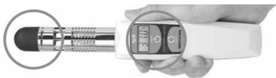
WBGT 測定器 作業現場のWBGT 値をチェック。必ず黒球付きのJIS 規格適合品を選ぶ。太陽光のある場所、ない場所と条件が異なるので、こまめに実測することを奨めている
