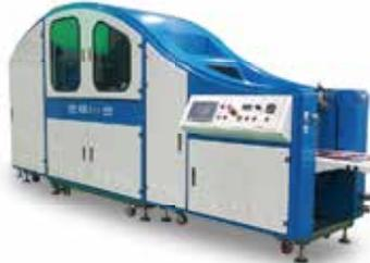
KBDきらりは、小ロットでもロングランにも適したデジタルコーティングシステム。箔押しも標準装備しており、スポットニスとの融合で高品質で立体的な仕上がりを実現! コロナ処理を標準装備しており、様々なデジタル印刷物にも対応。デジタルコーティングなので版が必要なく、様々な印刷データを短時間でセットでき、納期短縮も可能となりました。
