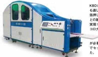
KBDきらりは、小ロットでもロングランにも適したデジタルコーティングシステム。箔押しも標準装備しており、スポットニスとの融合で高品質で立体的な仕上がりを実現! コロナ処理を標準装備しており、様々なデジタル印刷物にも対応。デジタルコーティングなので版が必要なく、様々な印刷データを短時間でセットでき、納期短縮も可能となりました。
